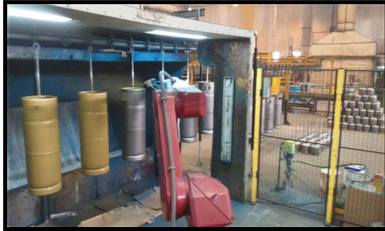
Figura 6 – Processo de Pintura
