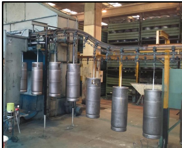
Figura 5 – Transporte por esteira
