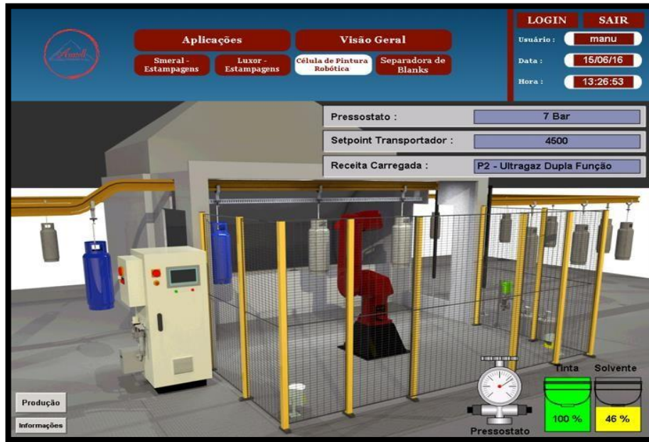
Figura 8 – Tela do sistema supervisório
