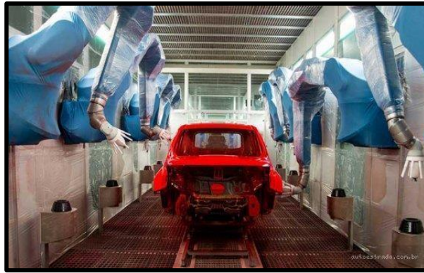
Figura 4 – Processo de pintura automático
